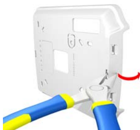
Figure 2 : Détachement de la languette en plastique pour le câblage en surface
